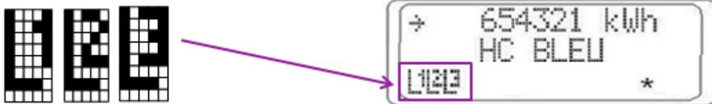
**Indicateur de sens de l'énergie :** ce symbole apparaît lorsque l'énergie active transite dans le sens aval vers amont (du client vers le réseau).
