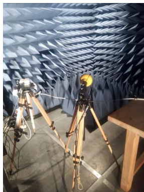
Figure 3-3 : mesures de champ magnétique et de courant électrique en amont et en aval d'un compteur Linky
