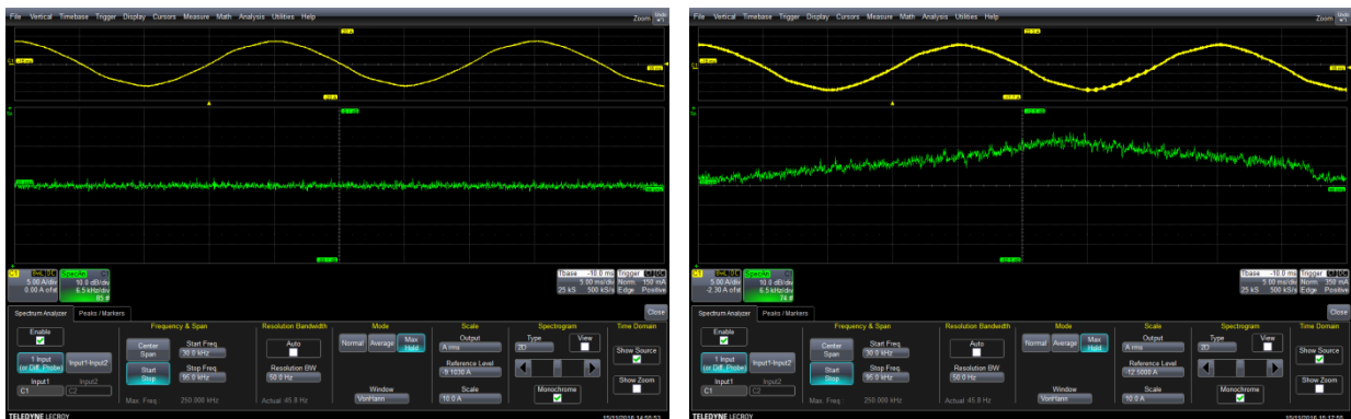
Figure 3-10: mesure de courant (temporel et spectre dans la bande CPL Linky) – mesures en amont du compteur G3, avec charge n°3 « radiateur 2000W » : sans communications CPL (à gauche) et avec communications CPL (à droite)
