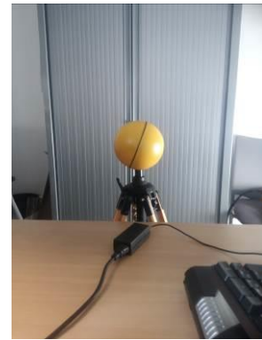
Figure 5-3: niveau de champ magnétique dans la bande de fréquences utilisée pour le CPL Linky Mesure sur un poste de travail, à 20 cm d'un bloc chargeur / alimentation d'ordinateur portable
