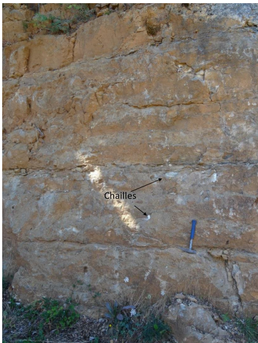
Figure 15 : Barre massive de calcaire à chailles du Bajocien inférieur (Vebron) (photo C. Araïgno).
