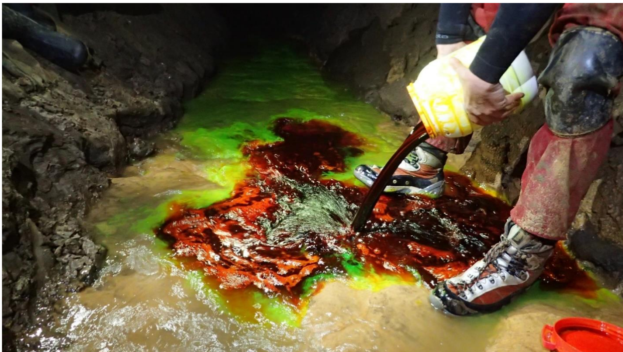
Figure 49 : Injection du traceur à -400m, aven de la Cheminée (T2a).
