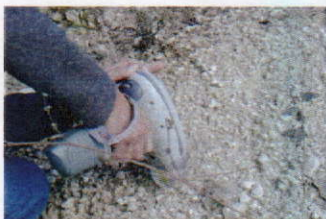
Prélèvements et analyses in situ à la fluorescence X (Niton®)
