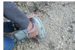
Prélèvements et analyses in situ par fluorescence X (Niton®)
