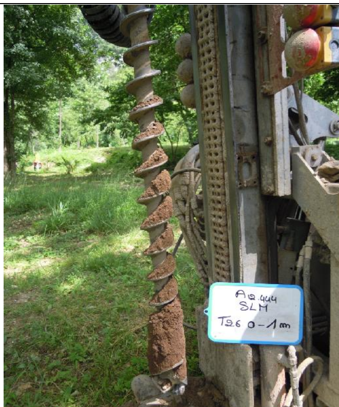
Photographie des sols compris entre 0 et 1,00 m de profondeur
