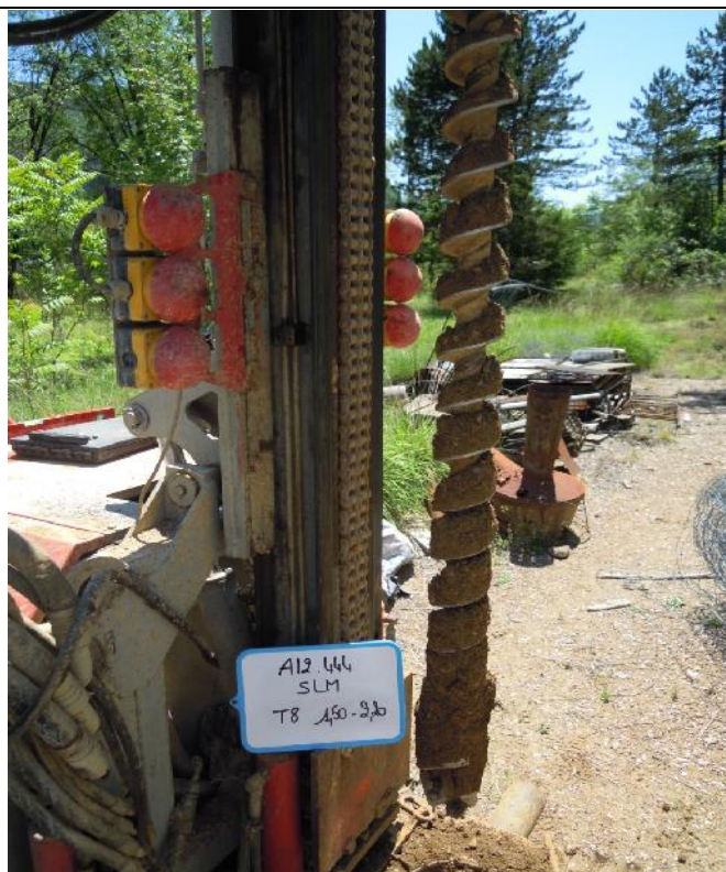
Photographie des sols compris entre 1,50 et 2,20 m de profondeur
