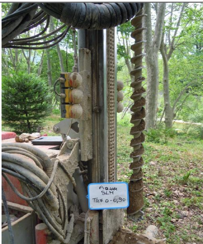
Photographie des sols compris entre 0 et 0,90 m de profondeur
