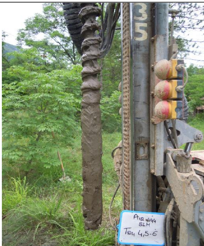
Photographie des sols compris entre 4,50 et 5,60 m de profondeur
