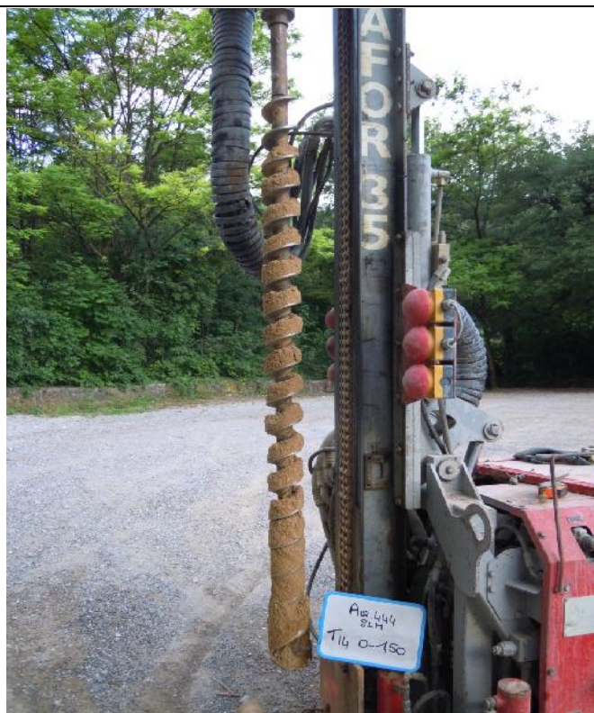
Photographie des sols compris entre 0 et 1,50 m de profondeur
