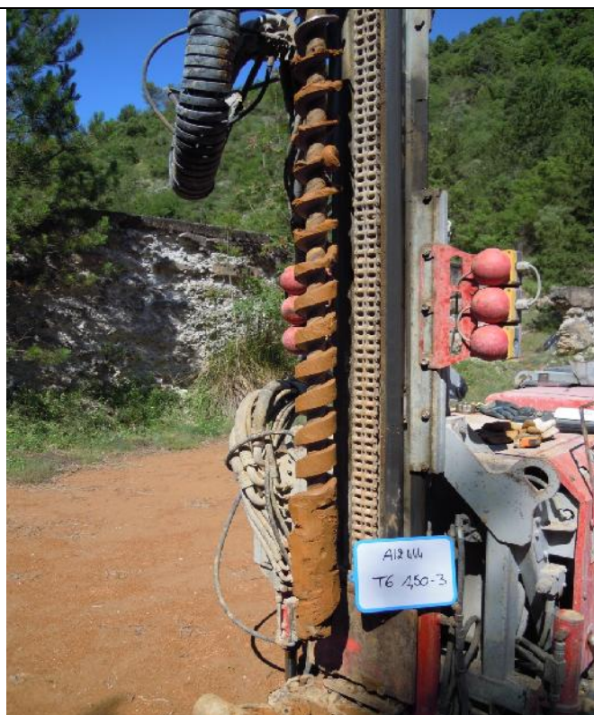
Photographie des sols compris entre 1,50 et 3,00 m de profondeur
