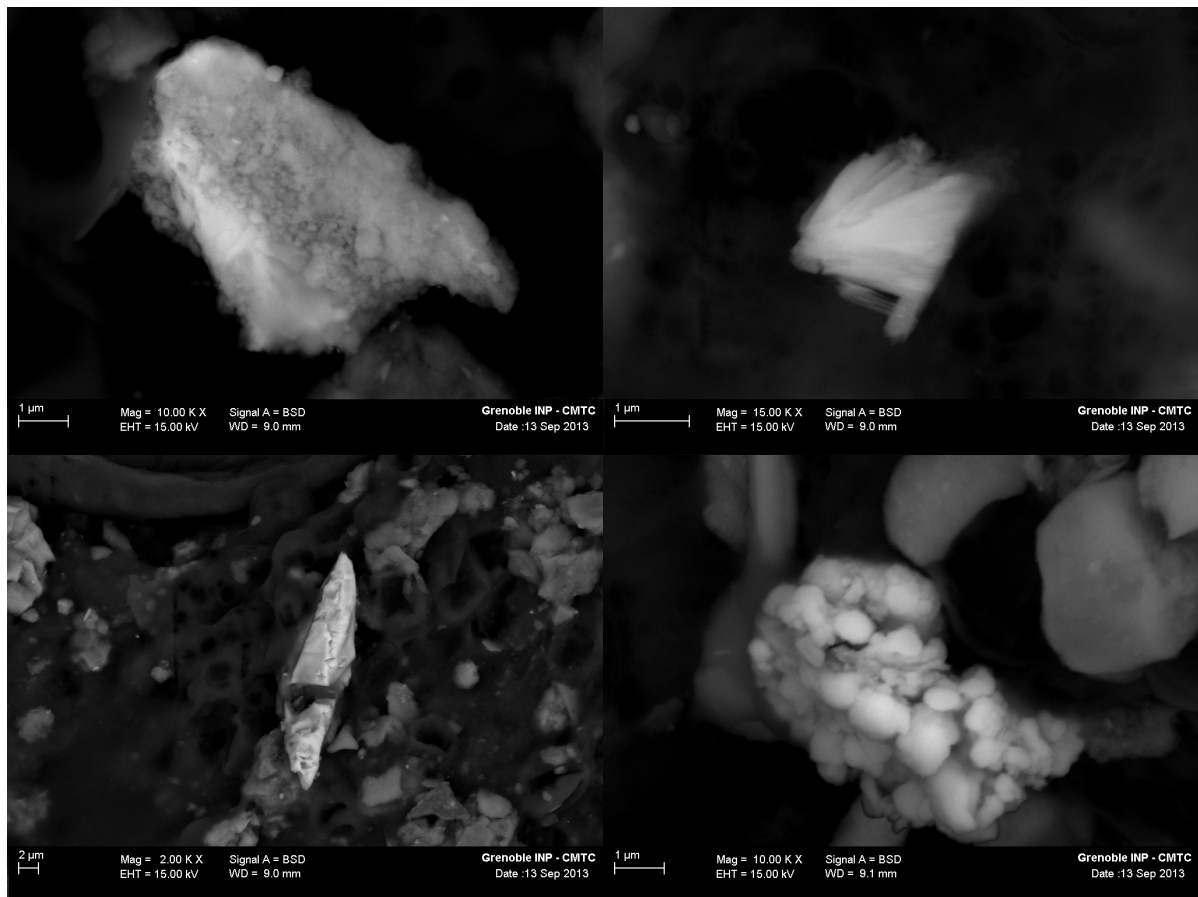
Figure 3 Oxyde de Fe sous forme d'agrégats et anguleuses. Ces formes d'oxyde de Fe sont différentes de ceux observés dans les autres sites, indiquant une source différente pour ces oxydes de Fe (source trafic ?)
