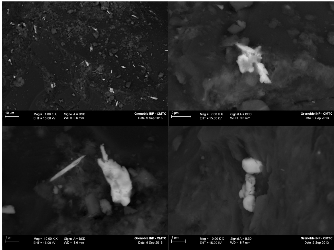
Figure 8 Présentation d'un grand nombre d'oxydes de Pb (blanc) parsemés dans cette source et présentant différentes formes (aiguille, amas, bille), d'environ 1-10μm.
