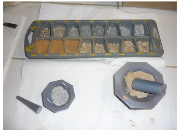
Figure 11 : Photographie du broyage des échantillons
