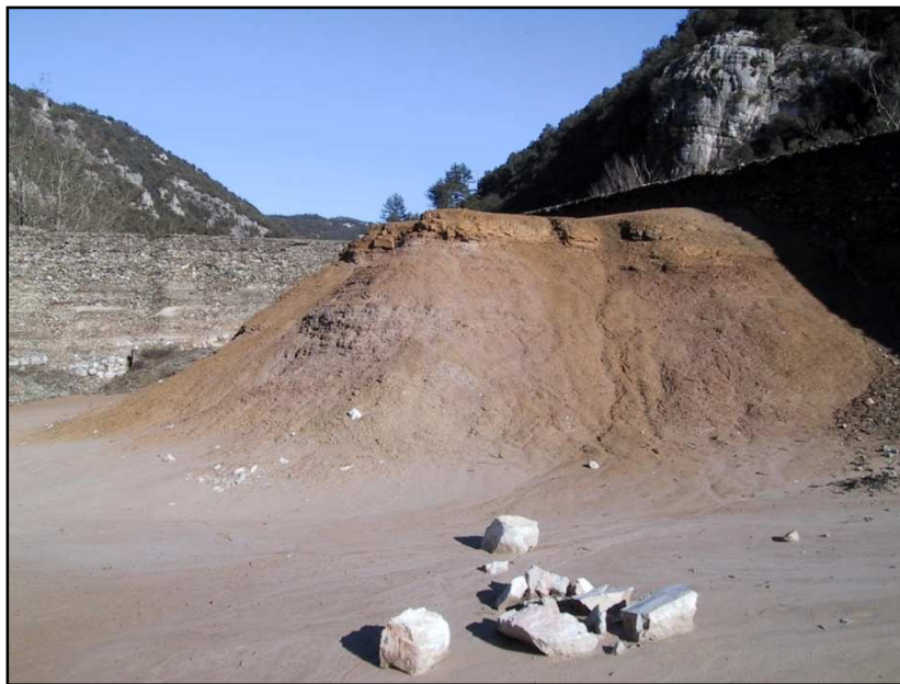
Photo 2 : Résidus miniers contenus dans les bassins de décantation situés en bordure de la Vis
