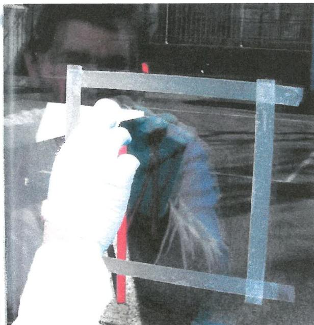
*Figure 1 : Prélèvement de poussières par frottis (ici sur une porte fenêtre d'accès à l'école)*
