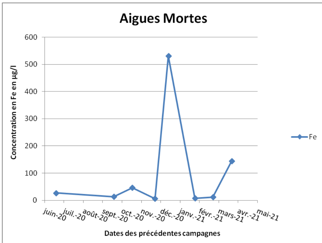
Figure 9 : Comparaison des concentrations en Fer (sur eau brute) en fonction des campagnes au droit de l'Aigues-Mortes
