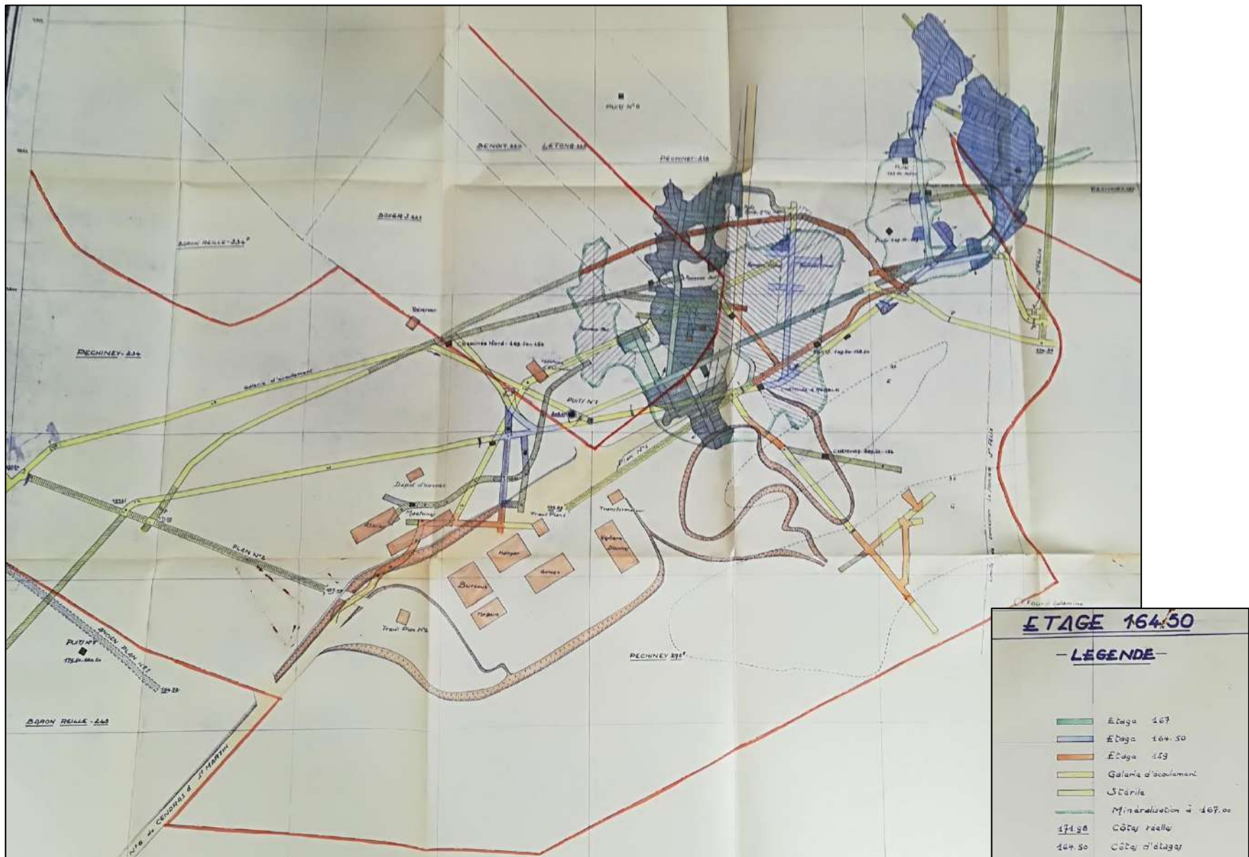
I- Le Soulier – Quartier de Bessourides - Plan des travaux souterrains et des installations de surface de 1955
