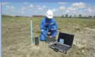
Relevé de sondes Diver sur le terrain
