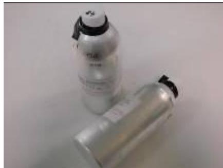
Photo 1 : Flacons pour le prélèvement d'eau et la mesure du 222Rn
