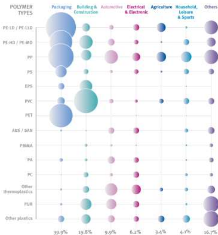
Figure 1: Utilisation des différentes résines pour les principaux types d'usages (données Plastics Europe, 2019)
