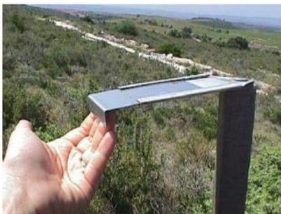
Les plaquettes qui étaient jusqu’à présent utilisées pour la mesure des poussières sédimentables sont remplacées par des jauges de 10 L maintenus par un trépied.
