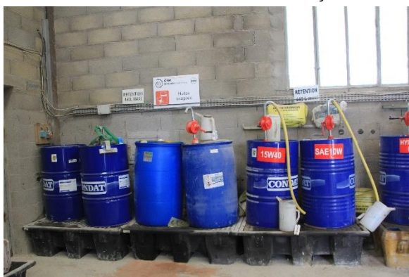
Fûts sur rétention dans l'atelier de Bagard
