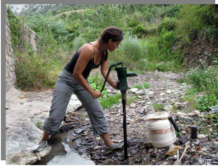
Pompage du sous-écoulement de Valunès à l'aide de la pompe Bou-Rouch.
